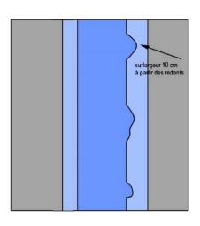
Concernant les surfaces à reprendre, la réfection intégrera la largeur de la tranchée et une sur largeur de 10 cm de part et d'autre en respectant une surface rectiligne (cf. croquis précédent), avec une couche d'accrochage. Les joints périphériques de tranchée seront traités à l'émulsion de bitume et sable par du matériau concassé 2/4, ceci afin de garantir l'étanchéité du revêtement de chaussée
